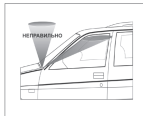
Рис.1 Направление датчика реле в салоне автомобиля
